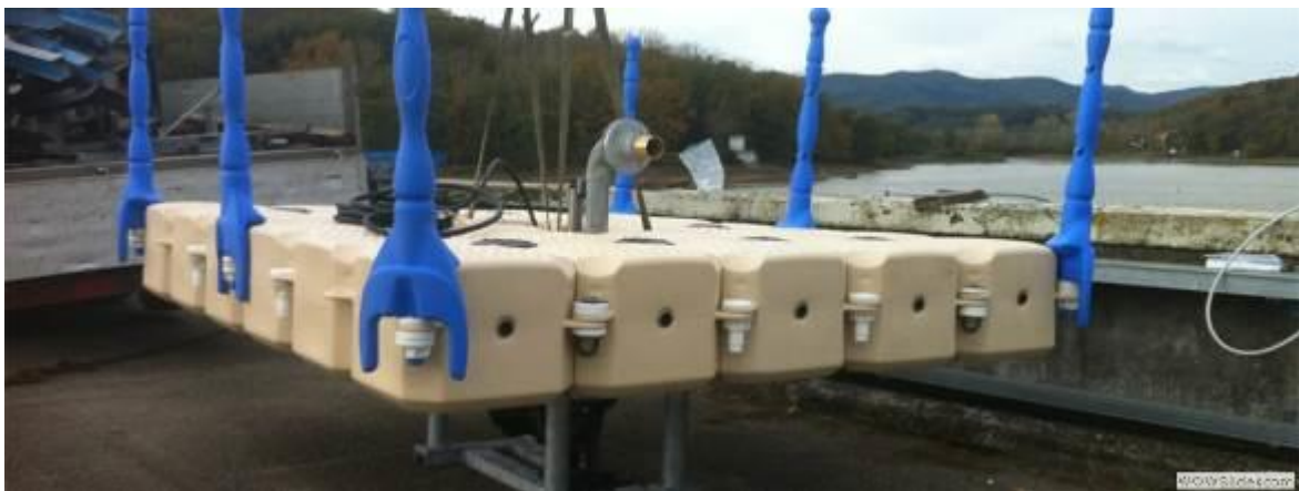
Piattaforma con telaio metallico e pompa immersa per pompaggio acqua da bacino idrico, con tubazione tenuta a galla da ulteriori galleggianti cubedock.
