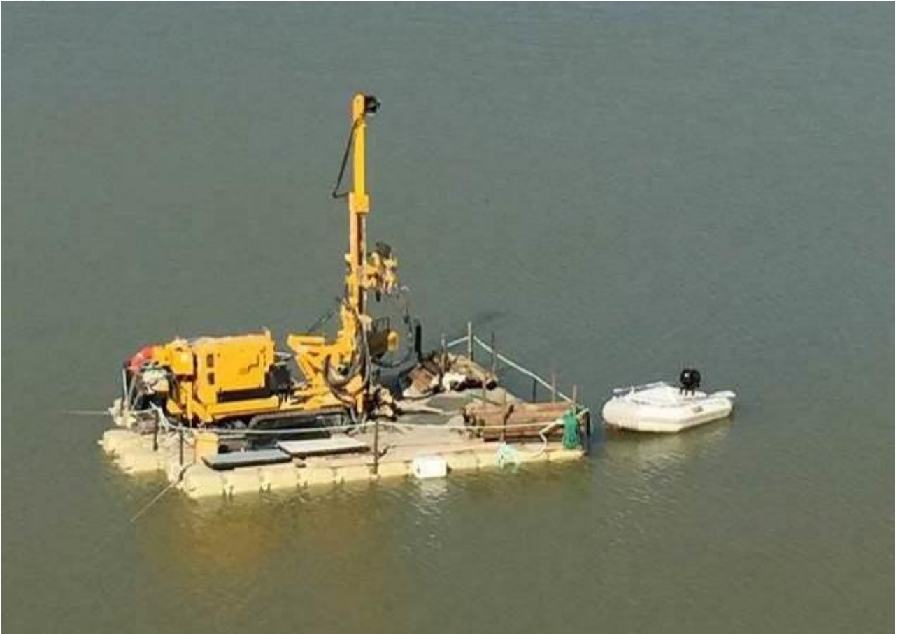
Piattaforma 500x550cm in cubedock per trasporto e lavorazioni in acqua con carotatrice – trivella di peso oltre 3000 kg
